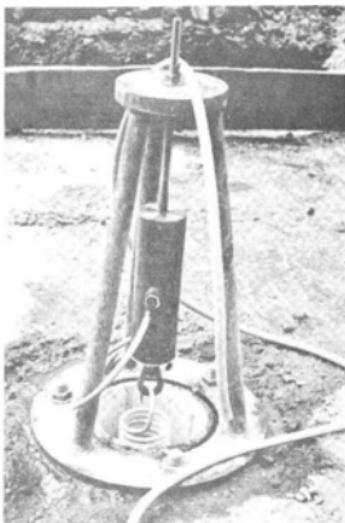
Fig. 19 Ressort et corde vibrante
