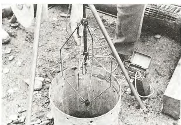
Fig. 10. — Micromoulinet à axe vertical à compte-tours électronique pour la mesure des vitesses ascensionnelles dans les puits de pompage (Soléstanche).
