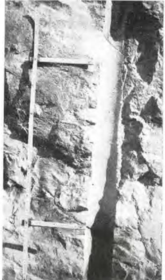
Bild 6. Im grossen Bohrloch hat das Luftpolster den Fels geschont. Die durch den Doppelmeter bezeichneten Sprengstellen waren einzig an Rauchspuren zu erkennen
