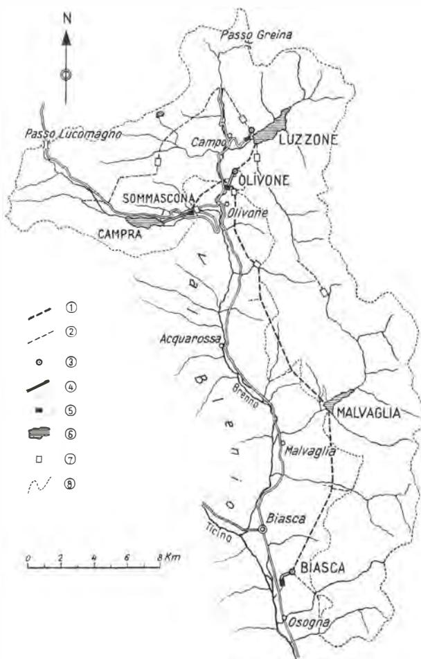
Abb. 1 Uebersichtsplan der Blenio-Kraftwerke mit Eintragung der Stollenstrecken durch Trias. Die Partien durch ungünstige karbonatische Trias sind mit □ angegeben.
