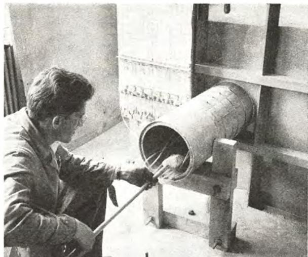
Fig. 6. — Essais sur modèle en laboratoire : extraction du sable.
