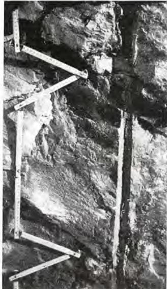
Bild 5. Im kleinen Bohrloch haben die dicht anliegenden Ladungen den Fels örtlich zerschlagen und auch auf der Verdämmungsstrecke einen senkrecht zur Wandoberfläche laufenden Riss hinterlassen
