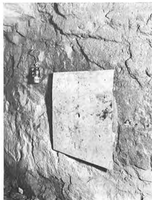
Bild 4. Blechschalung der an die Stollenwand betonierten kreisrunden Druckplatte mit \varnothing 80 cm. Zentrales Loch zur Messung der Stollendehnung an der Felsoberfläche
