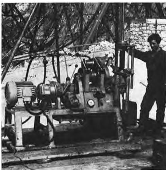
Bild 2. Schnelldrehende Rotationskernbohrmaschine mit hydraulischem Vorschub
