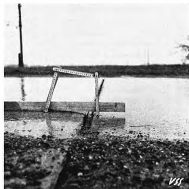
Fig. 4. Dé nivellements maximales: 2 cm de dalles de béton non goujonnées. Déviation d'Assens. Dalles de béton 14 cm; fondation 20 cm
