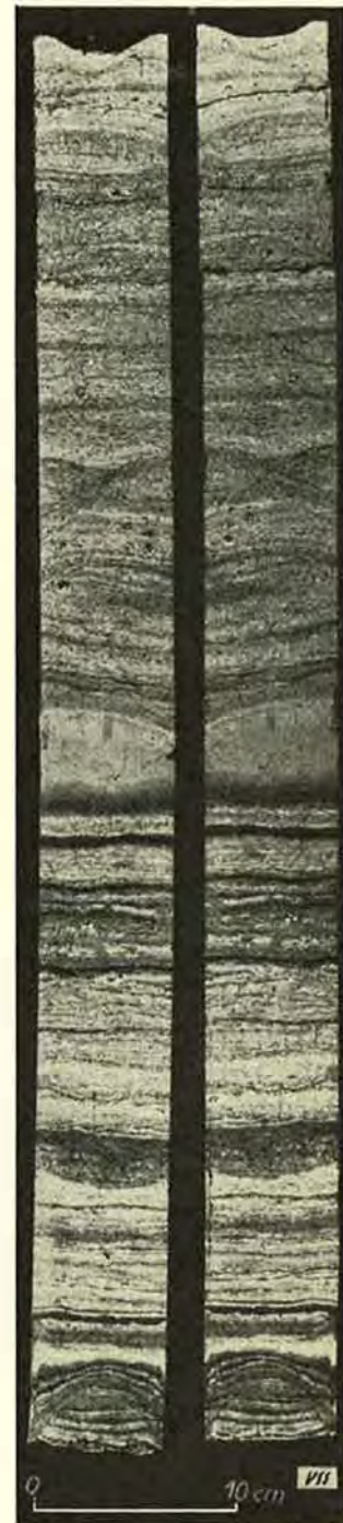
Abb. 7. Mit Kolbenentnahmegert gewonnene ungestörte Seekreideprobe, Länge 70 cm. Trotz sehrstrukturempfindlichem Material bleibt die horizontale Lagerung der Schichtenerhalten. Auch am Rand sind keine Störungen durch Mantelreibung zu erkennen (Photo E. Brügger).
