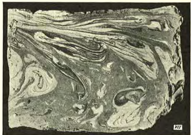
Abb. 3. Längsschnitt einer unsachgemäß entnommenen Probe mit starker Durchmischung (Photo E. Brügger)
