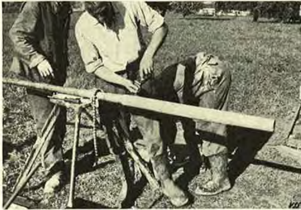
Abb. 6. Ansicht des Kolbenentnahmegertes. Durch Drehen der Schraube wird die automatische Klemmvorrichtung gelöst (Photo Groebli).
