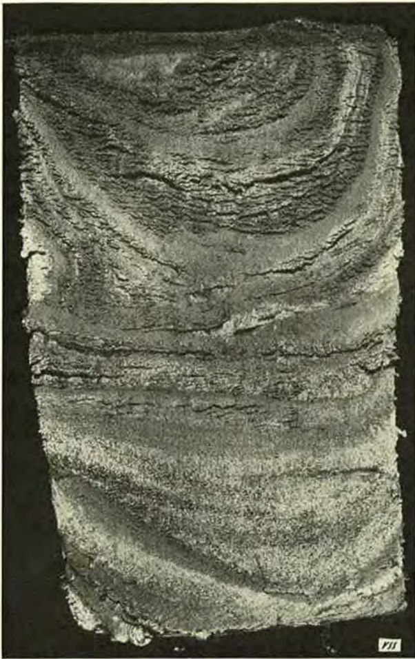
Abb. 2. Gestörte Probe, Aufwölbung infolge Mantelreibung. Oben Längsschnitt, rechts Querschnitt, etwa Zweidrittel der natürlichen Größe (Photo E. Brügger).
